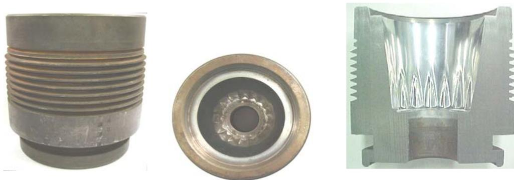
**Figura 10.** Molde de vidro – processo de prensagem – Caso 3.
