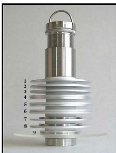
**Figura 1.** Cupons de alumínio e aço inoxidável colocados em um suporte de aço e isolados entre si por anéis de cerâmica.
