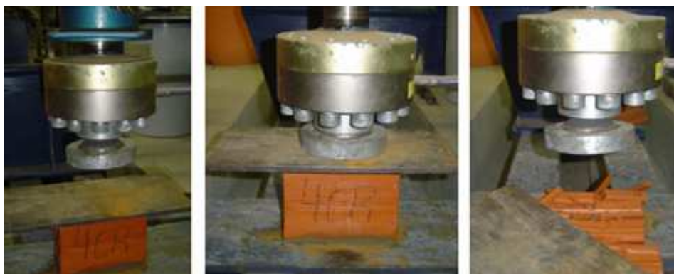
Figura 5. Ensaio de resistência à compressão dos blocos cerâmicos.
