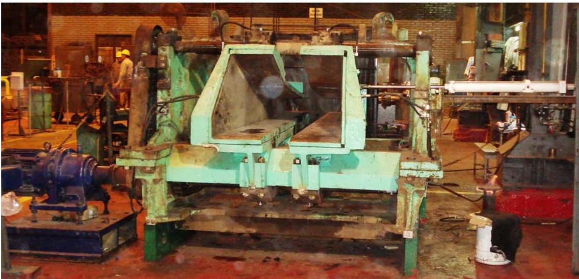
**Figura 1.** Prueba en Taller de mesa de entrada a Terminadores (16 horas abriendo y cerrando).
