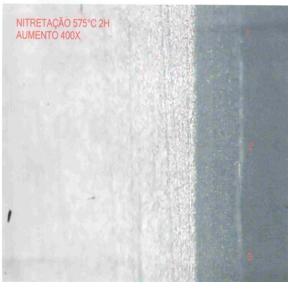
**Figura 4** - Micrografia da amostra ao Microscópio Óptico Digital, mostrando a camada branca nitretada em banho de cianeto, por 2:30 h.
