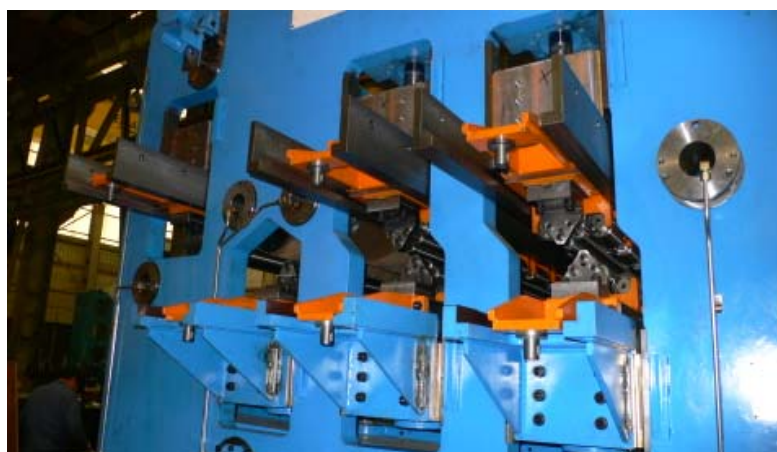
Figura 9. Foto ilustrativa dos cassetes da TL montados no equipamento.
