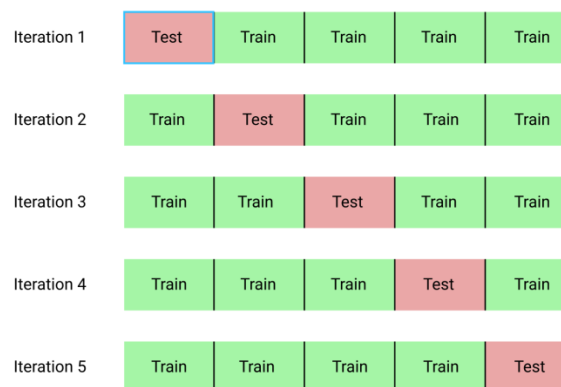
Figura 2e: Esquema de iterações do Cross-Validation
