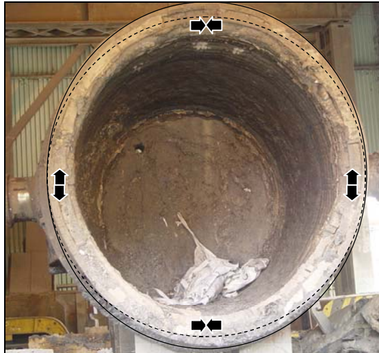
Figura 5. Fotografia de uma panela de aço evidenciando a deformação radial.
