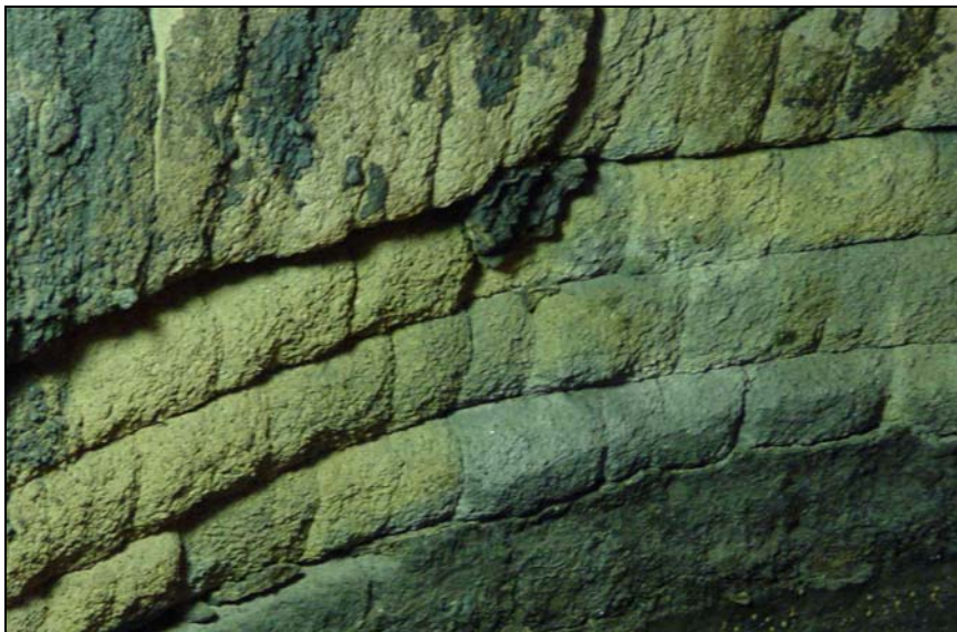
Figura 8. Fotografia do revestimento para linha de escória após 80 corridas, evidenciando a superfície descarbonetada dos tijolos de MgO-C (MC5).
