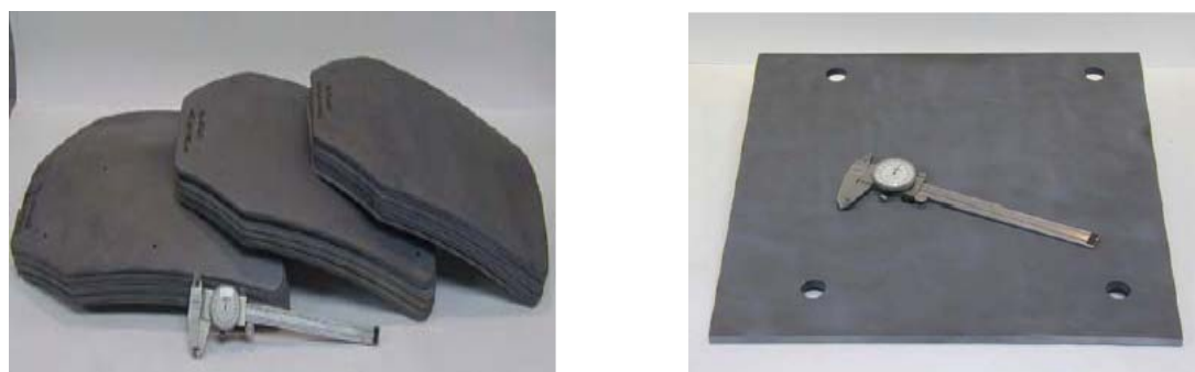
Figura 3. Novas blindagens (placa de colete e piso de aeronave) obtidas através de sinterização reativa [6].
