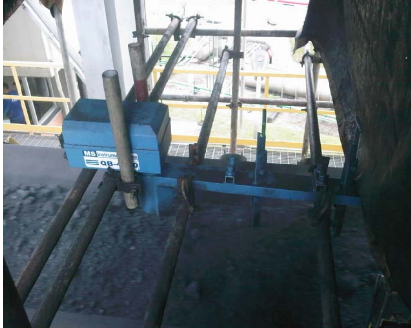
Figura 12. Umidade em coque – Alto Forno
