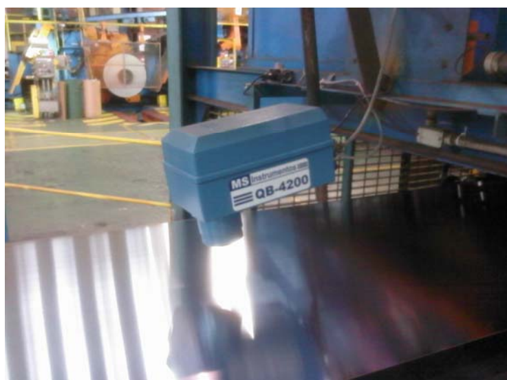
Figura 6. Analisador NIR na Industria metalurgia - Estanhamento
