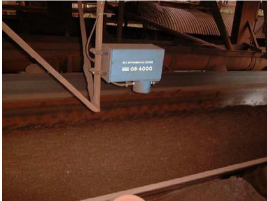
Figura 8. Umidade em polpa de minério de ferro
