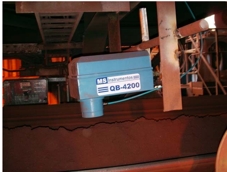
Figura 3. Analisador NIR instalado para medição de umidade em minério de ferro.
