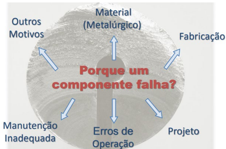
Figura 1. Fatores que provocam falhas em componentes Fonte: Ruchert (2014)
