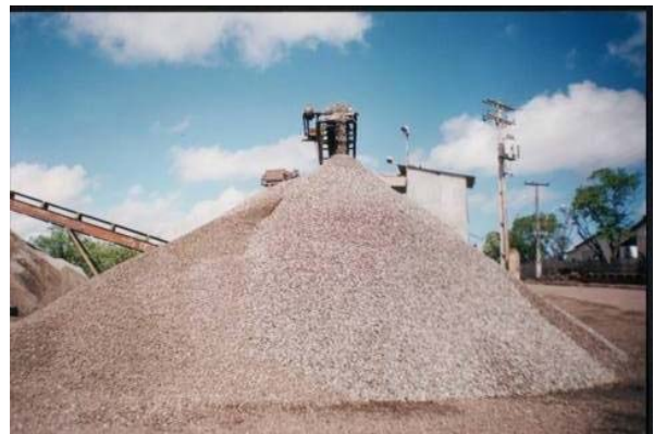
Figura 1 – Escória de alto-forno de manganês bruta e Figura 1b sendo britada e separada por peneiras em granulometrias diferentes.
