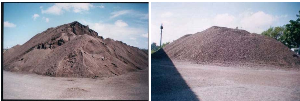
Figuras 2 e 3 – Escória de alto-forno de manganês já peneirada em granulometrias diferentes.
