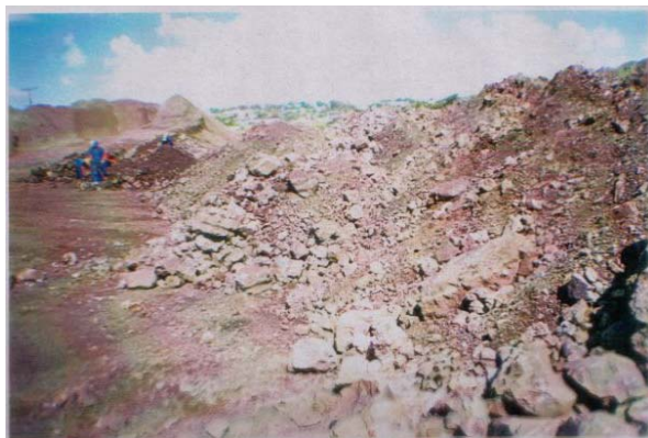
Figura 1 – Escória de alto-forno de manganês bruta e Figura 1b sendo britada e separada por peneiras em granulometrias diferentes.
