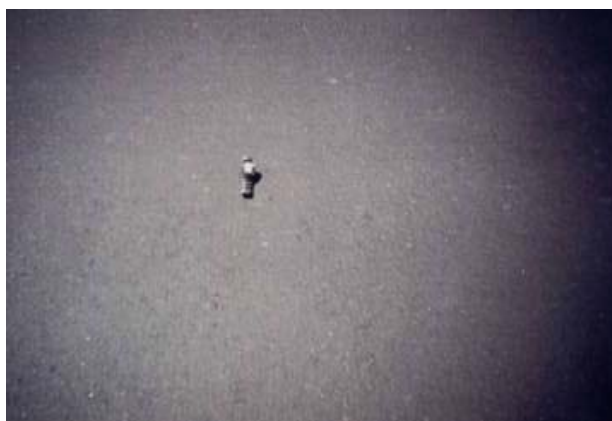
Figura 7 - Pavimentação asfáltica feita com escória de alto-forno de manganês.
