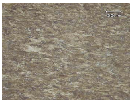
Figura 20 : Microestrutura – aumento 500x – reagente nital 2%.
