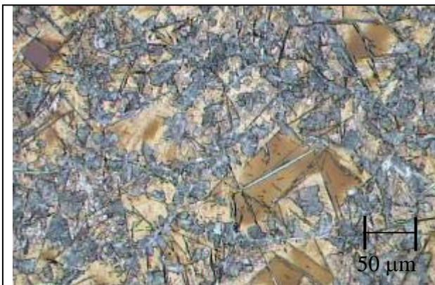
Fig(j) – resfriada em água e revenida 550°C/4h 200X (austenita + pacote de agregado fino de carb. e ferrita + precipitação no grão de agulhas finas de carbonetos + martensita).
