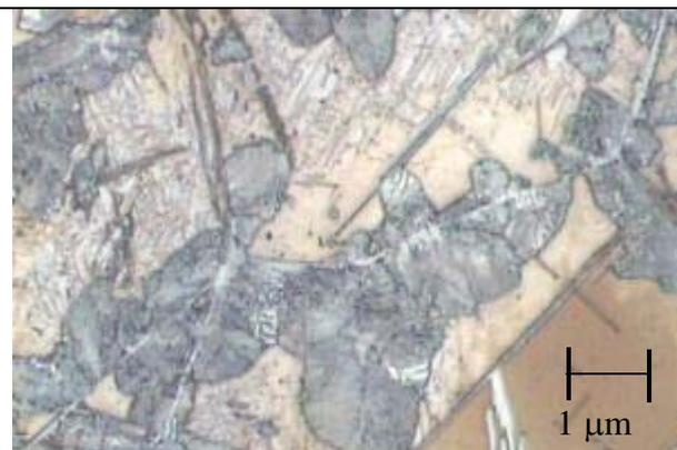
Fig (l)– resfriada em água e revenida 550°C/4h 1.000X (austenita + pacote de agregado fino de carb. e ferrita (acicular e lamelar) + precipitação no grão de agulhas finas de carbonetos + martensita).
