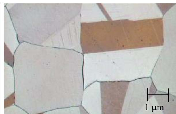
**Fig (c)** – resfriamento ao ar 1.000X (austenita + carboneto intergranular).
