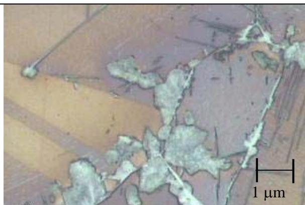
Fig(g) – resfriada em água e revenida 550°C/30min 1.000X (austenita + rede de cementita no contorno de grão + pacote de agregado fino de carb. e ferrita + precipitação no grão de agulhas finas de carbonetos).
