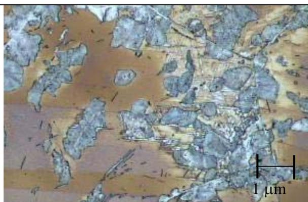
Fig(i) – resfriada em água e revenida 550°C/1h 1.000X (austenita + rede de cementita no contorno de grão + pacote de agregado fino de carb. e ferrita + precipitação no grão de agulhas finas de carbonetos + martensita).
