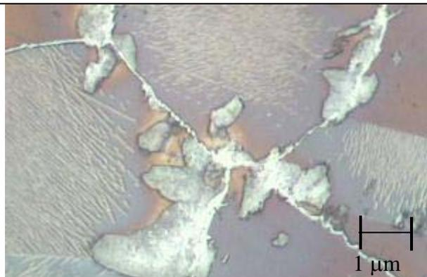
Fig (e) – resfriada no forno 1.000X (austenita + rede de cementita no contorno de grão + pacote de agregado fino de carb. e ferrita).
