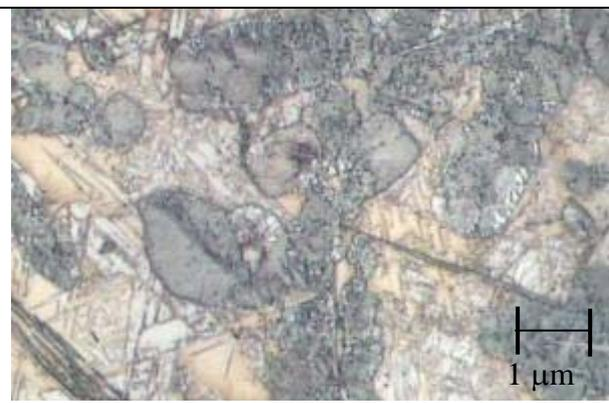
Fig (n)– resfriada em água e revenida 550°C/16h 1. 000X (austenita + pacote de agregado fino de carb. e ferrita (acicular) + perlita + precipitação no grão de agulhas finas de carbonetos + martensita).
