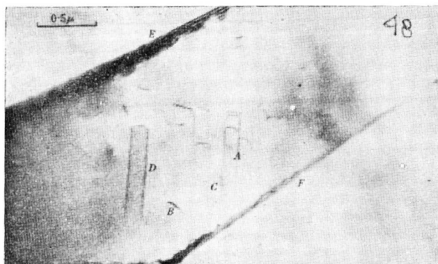
Fig. 48 — Discordâncias em aço inoxidável. Na figura seguinte, a discordância C movimentar-se-á até encontrar B (Whelan).
