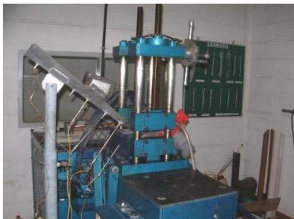
**Figura 4:** Laminador duo utilizado pelo grupo de pesquisa na obtenção de tiras metálicas.
