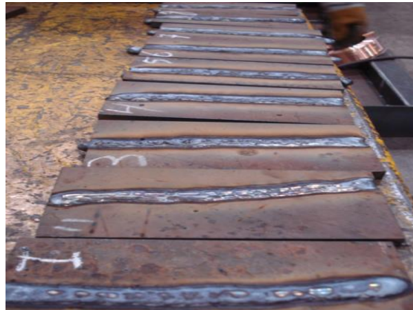
Figura 1 – Processo soldagem deposição simples ou “Bead on plate”
