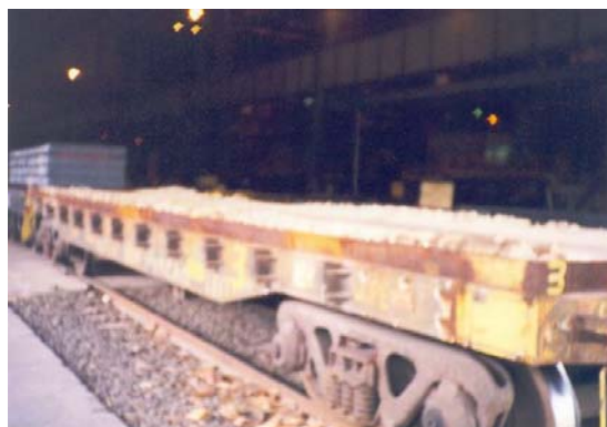
Figura 12 – Vagões plataformas revestidos com material refratário utilizados no transporte de placas quentes.
