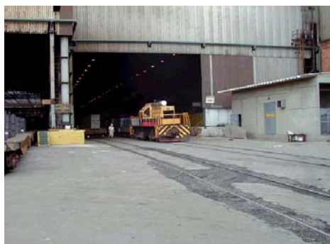
Figura 19 – Composição de vagonetas posicionada sem necessidade de separação do vagão madrinha.
