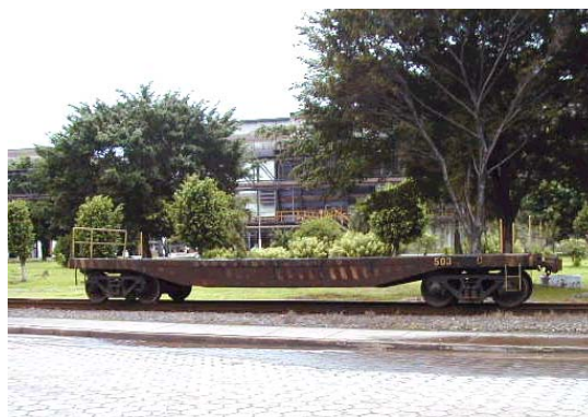
Figura 2 – Vagão plataforma madrinha para posicionamento do manobreiro à frente da composição.
