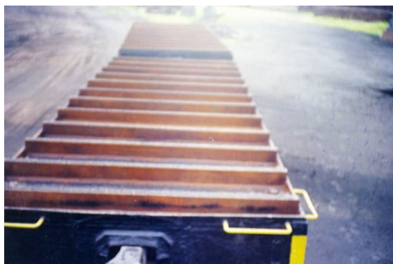
Figura 15 – Vagonetas adaptadas para o transporte de placas quentes.
