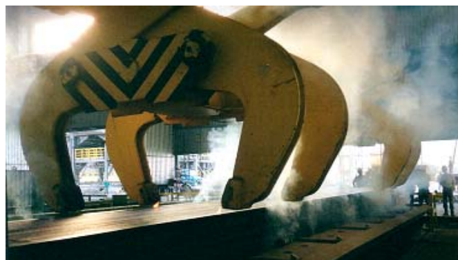
Figura 5 – Uso de tenaz para o carregamento de placas.
