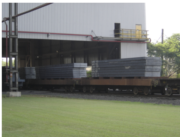
Figura 7 – Vagões carregados com placas no Pátio de Expedição da Máquina de Lingotamento 4.
