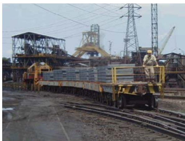
Figura 8 – Transporte de placas através de locomotivas operadas no modo convencional.
