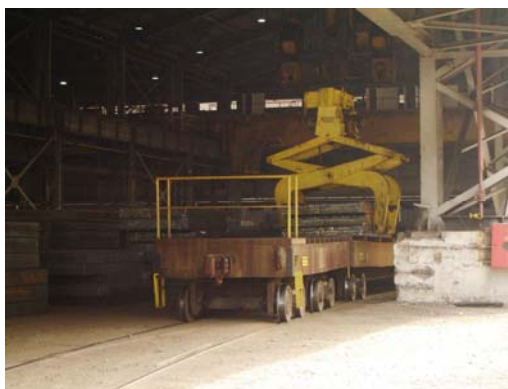
Figura 9 – Descarga dos vagões com pontes rolantes dotadas de tenaz.
