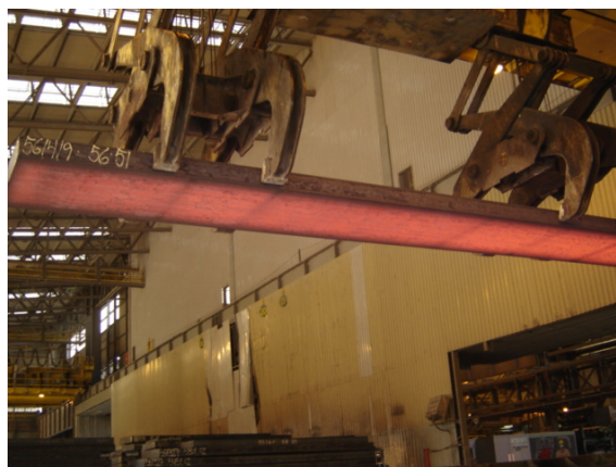
Figura 6 – Uso de tenaz para o carregamento de placas em vagões.
