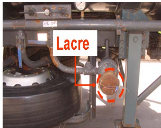
Figura 2 – Tampa de descarga com lacre travado por pino.
