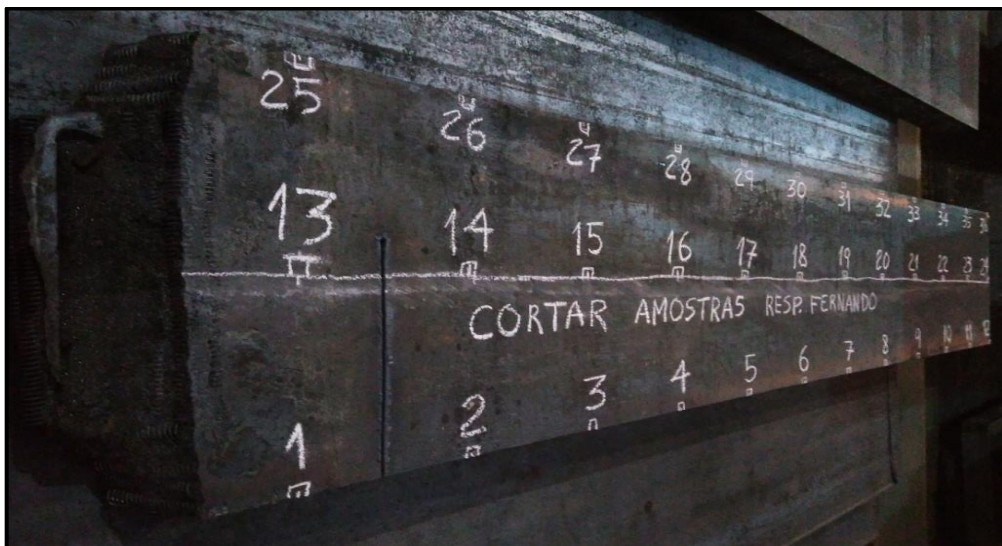
Figura 1 – Placa marcada para retirada de amostras ao longo do comprimento.
