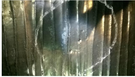
Figura 9 – Porosidade na superfície da placa revelada após a escarrafagem.
