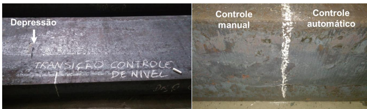
Figura 8 – Região de transição de controle de nível de aço no molde de manual para automático com defeito na região de controle manual (esquerda). Diferenciação da região de transição (direita).
