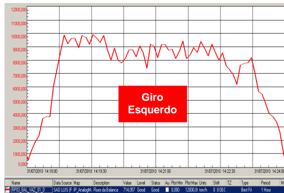
Figura 14 – Tempo em cada direção do giro após da implantação do controle de passo da translação
