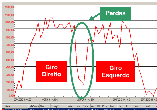
Figura 13 – Tempo em cada direção do giro antes da implantação do controle de passo da translação
