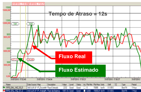
Figura 7 – Comparativo do fluxo estimado com o real
