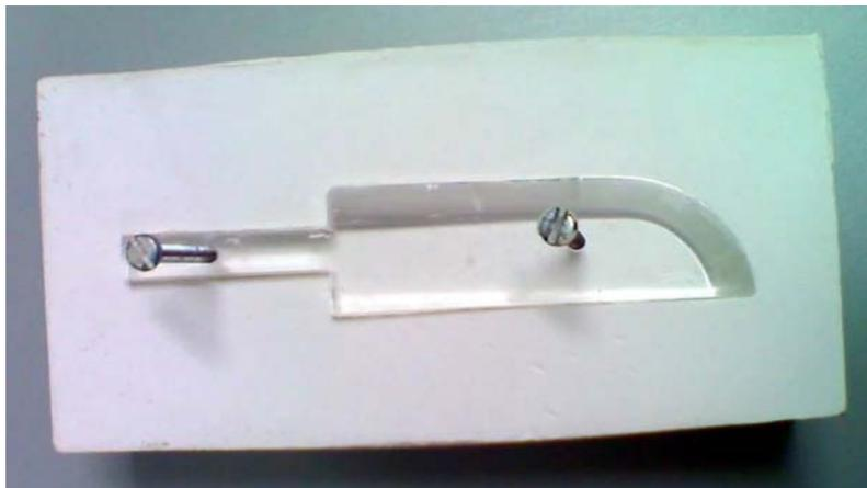
Figura 4: molde de gesso da faca de acrílico. Os parafusos foram colocados para auxiliar na remoção da faca de dentro do gesso.
