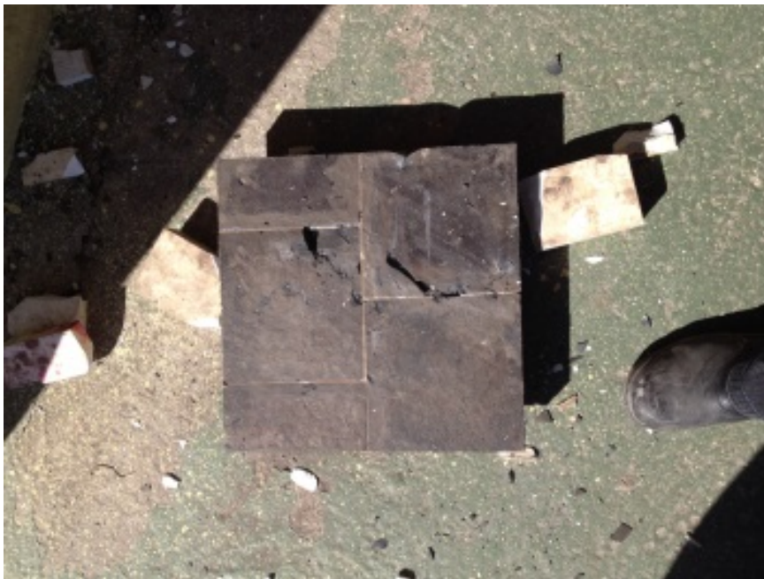
Figura 05: Erosão na placa de Abresist após impacto de 31J a 90°.
