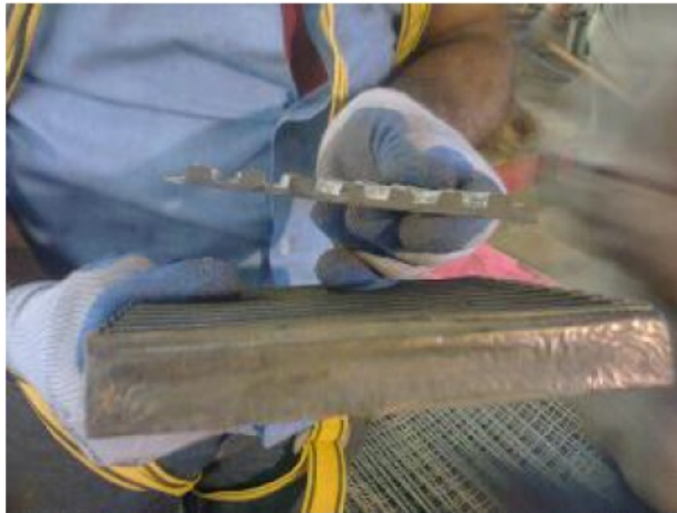
Figura 06: Diferenças de espessura de uma placa nova e outra desgastada por abrasão.
