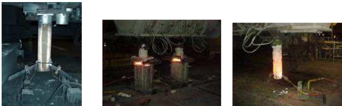
**Figura 9:** Sistema de aquecimento de tubo submerso em diferentes usinas brasileiras.
