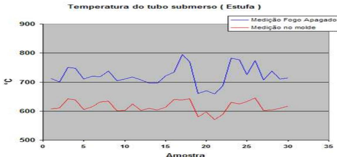
**Figura 8:** Monitoramento de temperatura por pirômetro ótico em tubos submersos nas MCC#2 e 3.
