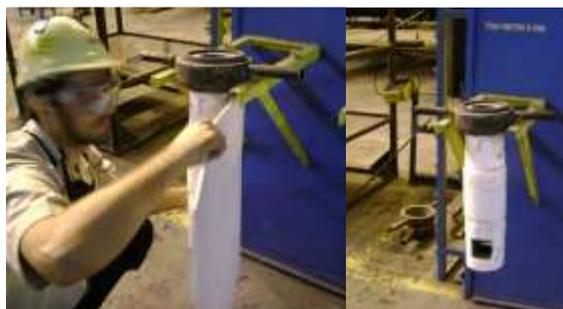
**Figura 10:** Aplicação de fibra cerâmica para proteção de tubos submersos.
