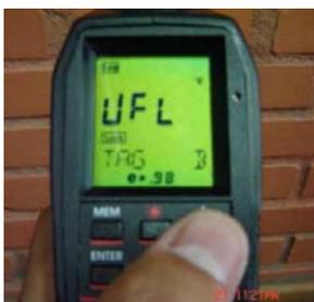
Figura 7: Ilustração da utilização de pirômetro ótico.
