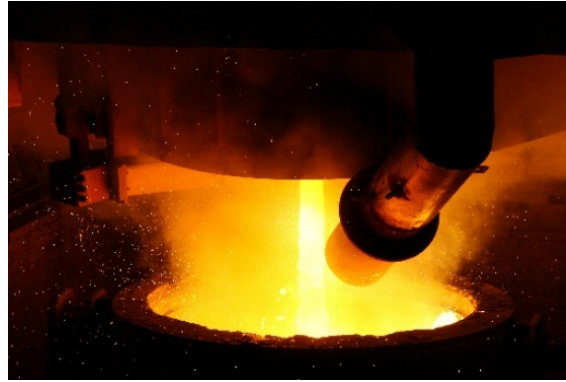
Figura 1: Garagem para o vazamento do FEA.
