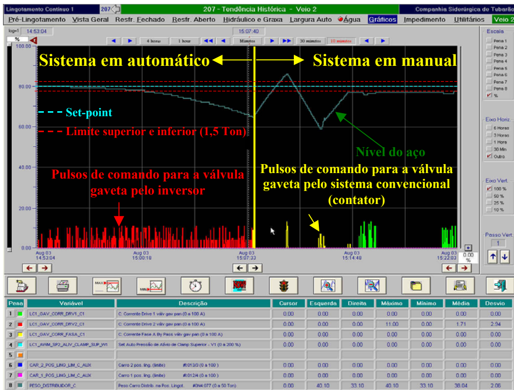
Figura 5. Nível de aço do distribuidor durante o vazamento da panela.
