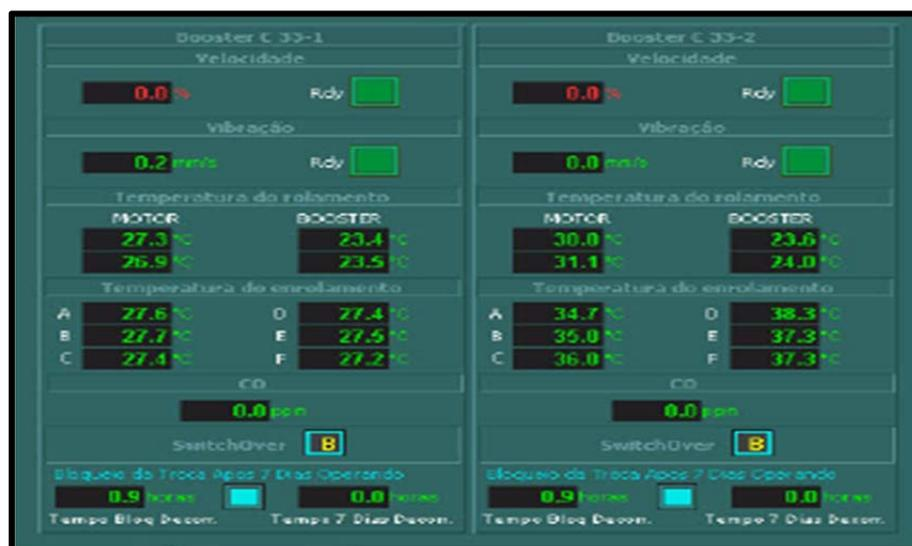
Figura 14. Janela de operação de switch over dos boosters de gás de Aciaria.
