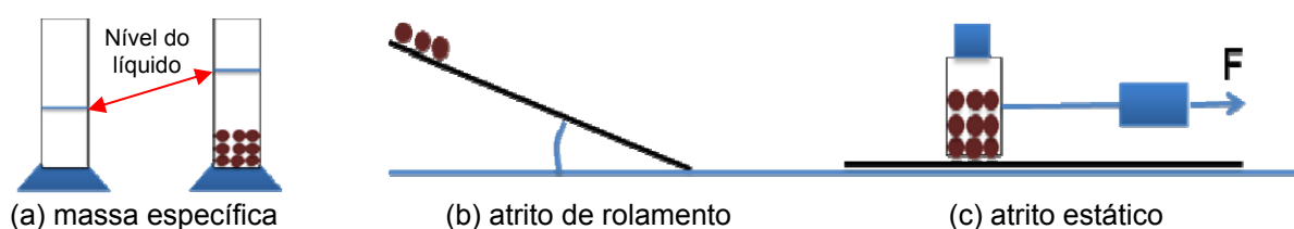
Figura 1. Esquema experimental para estimativa da massa específica, do atrito de rolamento e estático das pelotas.
