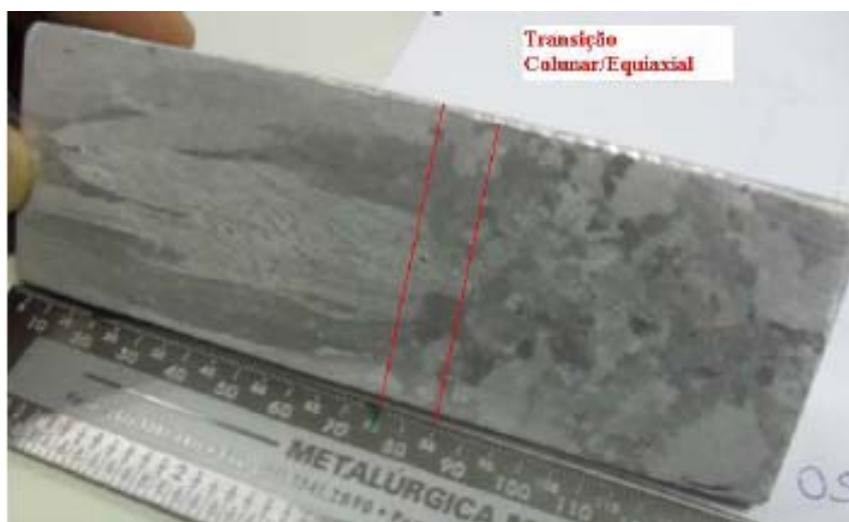
Figura 4. Macroestrutura da condição A.
