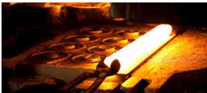
Fig. 5: Matriz de forjamento a quente, prensa excêntrica, com resultado 40% superior comparado com ferramenta com nitrocarbonetação convencional (COMBUSTOL).
