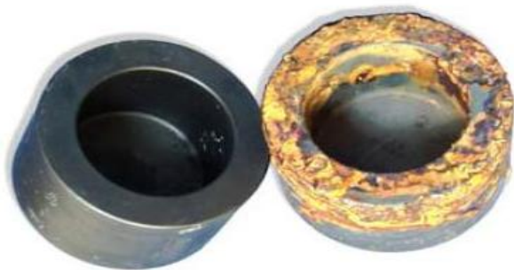
Fig. 2: Item produtivo ilustrando o efeito do processo NITREG na resistência à corrosão (NITREX).
