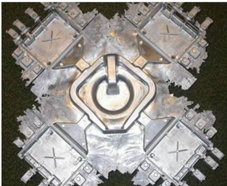
Fig. 6: Peça fundida em alumínio, via die cast, em molde de final de vida. Note a quantidade de rebarbas (ALUINFO)
