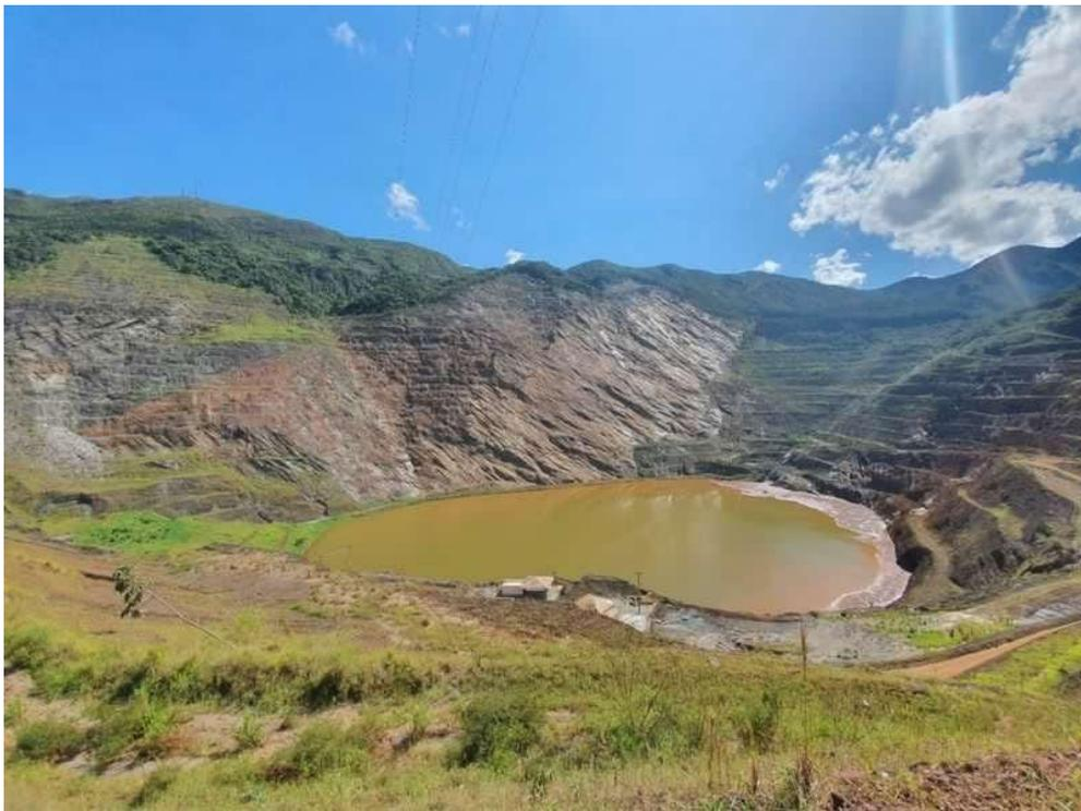
**Figura 2.** Vista da cava de Timbopeba com disposição de rejeitos.
