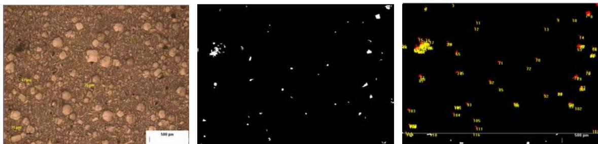
**Figura 5.** Medidas da porosidade através da foto microscópica (esquerda), binarizada (centro) e à (direita) análise da área e contagem dos poros.
