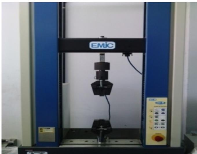
**Figura 8.** Máquina de ensaio de tração dos compósitos.
