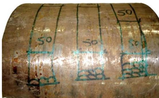
Figura 8. “Meia cana” preparada para ser soldada com os passes de Temper Bead.
