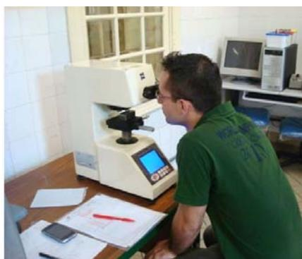
Figura 13. Análise de microdureza Vickers das peças soldadas.
