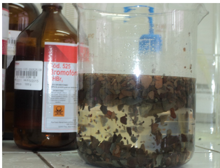
Figura 1. Ensaio de separação em meio denso.
