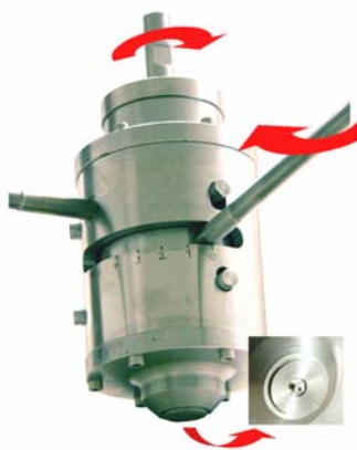
Figura 4. Cabeçote de soldagem para FSpW e KHC.
