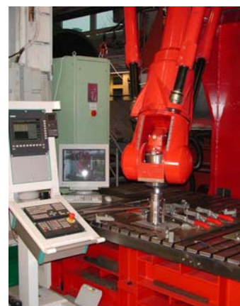
Figura 5. Cabeçote montado no Tricept 805.
