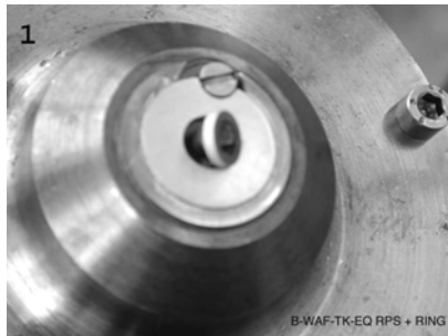
Figura 6. Representação do anel sendo colocado na ferramenta
