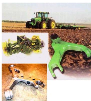
Figura 3 – Braço de direção em ADI para trator (Keough, 2002).
