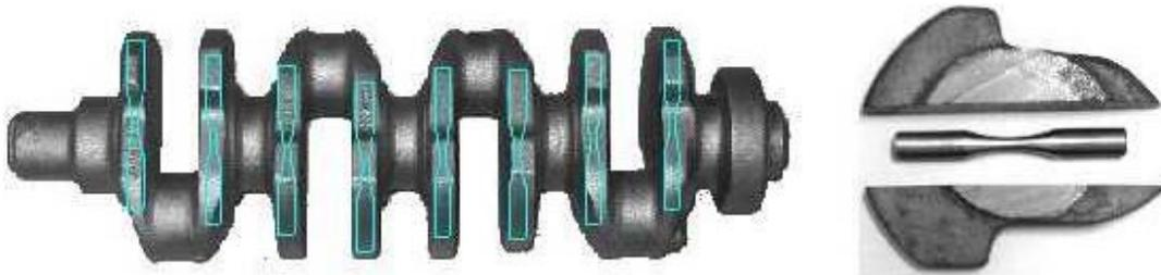
Figura 6 – Local de retirada dos corpos de prova no virabrequim.
