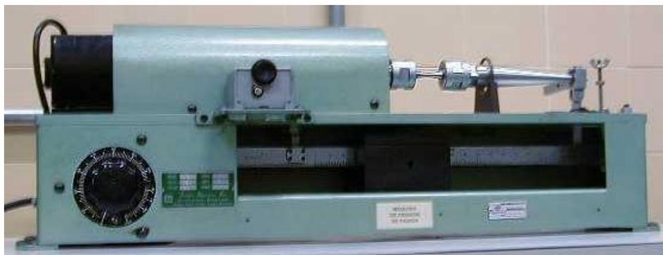
Figura 4 –Máquina de ensaio de fadiga por flexão rotativa – Modelo RBF-200.
