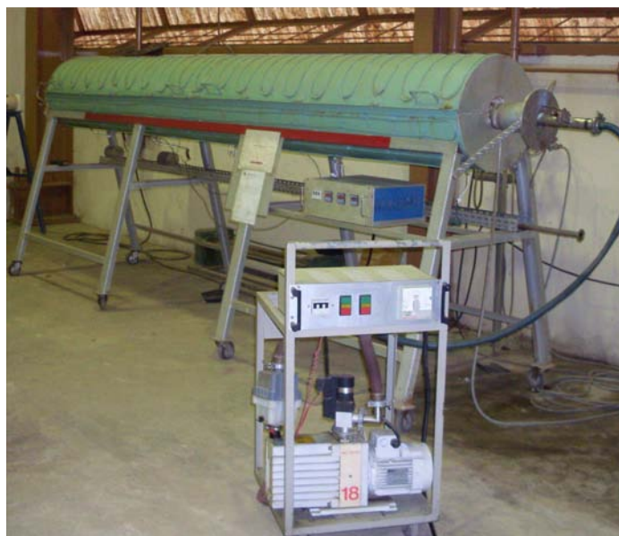
Figura 2: Forno tubular de 5 metros de comprimento.
