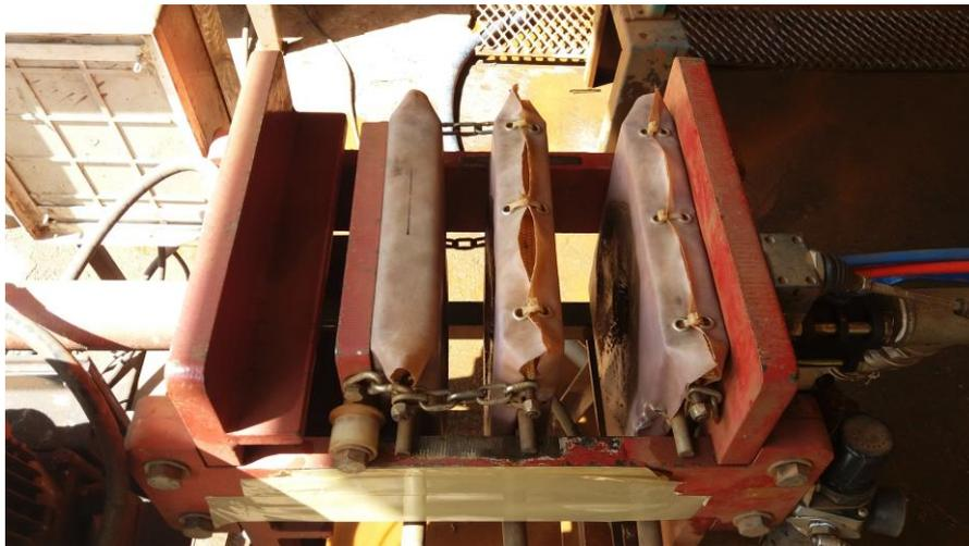
**Figura 4.** Filtro prensa piloto utilizado nos testes de laboratório
