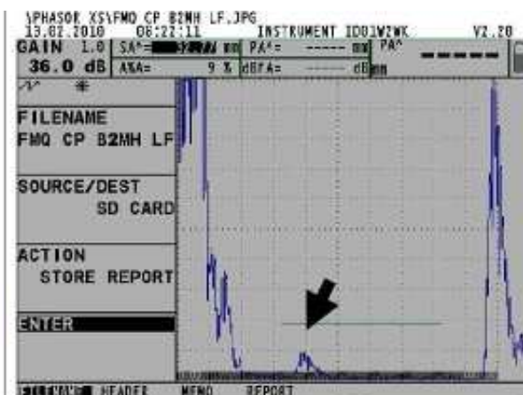
Eco de fundo com cabeçote B2S apresentando interface a 38 mm de profundidade, sem obstrução da passagem do som. Acoplamento lado Ferro
