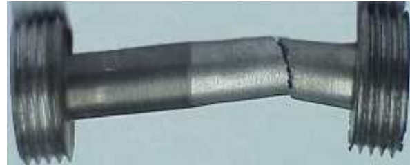
Figura 19: Corpo de prova, ruptura na área nodular
