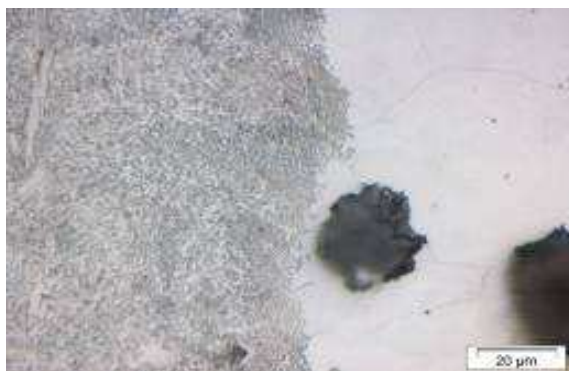
Figura 16: Aum. de 1000 x, Nital 2%, com nódulos
