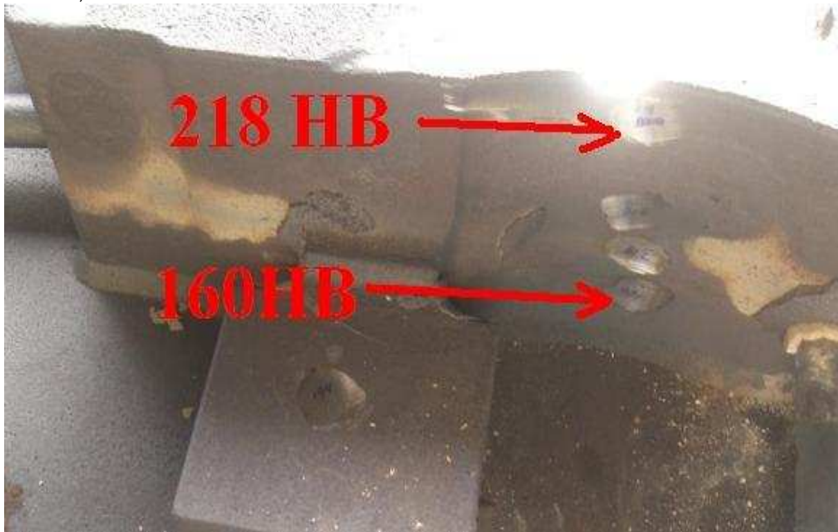
Figura 2: Testes de dureza, executados na matriz HYBRID®.
