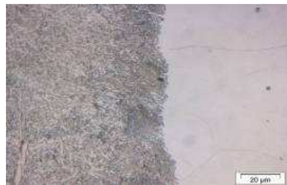
Figura 17: Aum. de 1000 x, Nital 2%, sem nódulos
