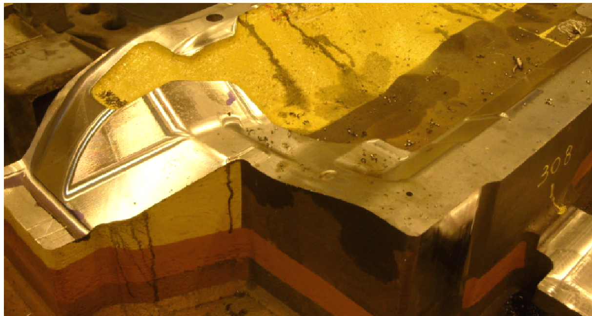
Figura 21: A matriz HYBRID® em fase de usinagem.
