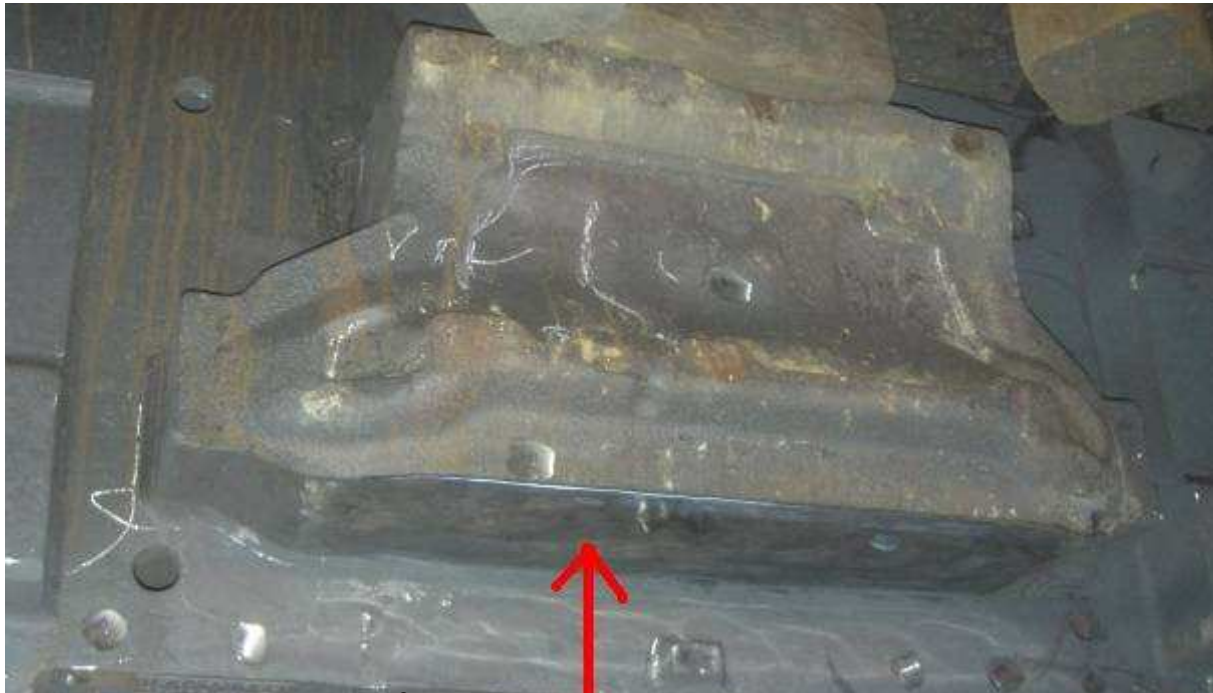
Figura 4: A matriz HYBRID ® , local de retirada da amostra de material na área da interface.
