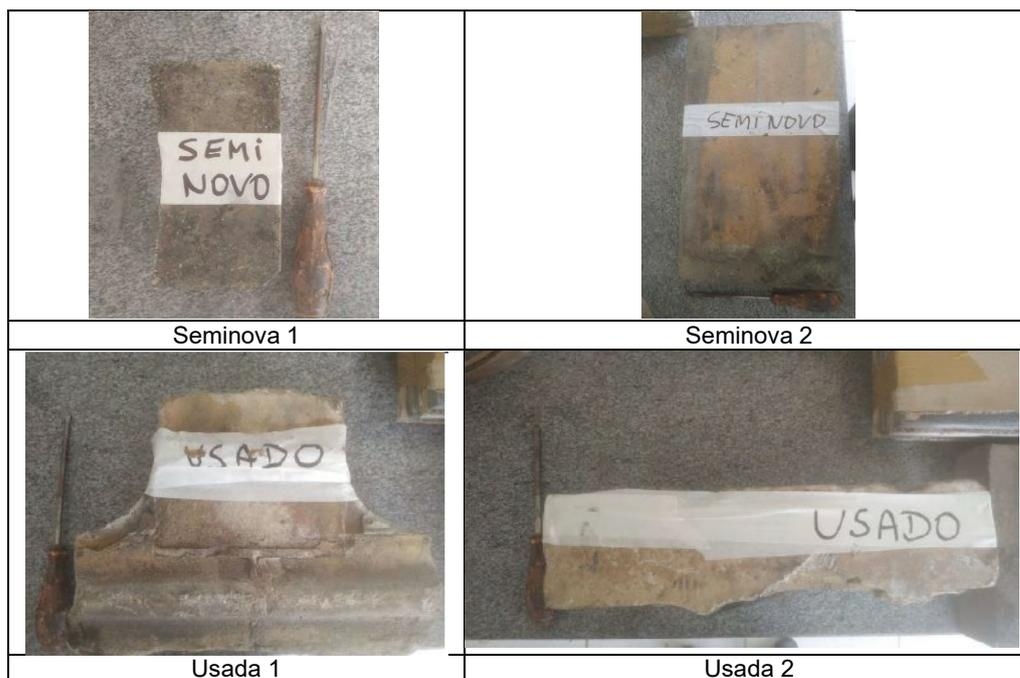
Figura 2. Amostras de tijolo refratário utilizados na bateria de coque.
