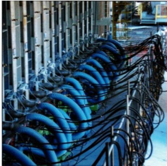
Figura 10. Posicionamento dos queimadores para controle de temperatura.
