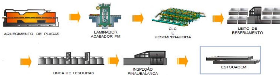
Figura 2. Esquema da Linha de Produção de Chapas Grossas com utilização do CLC.
