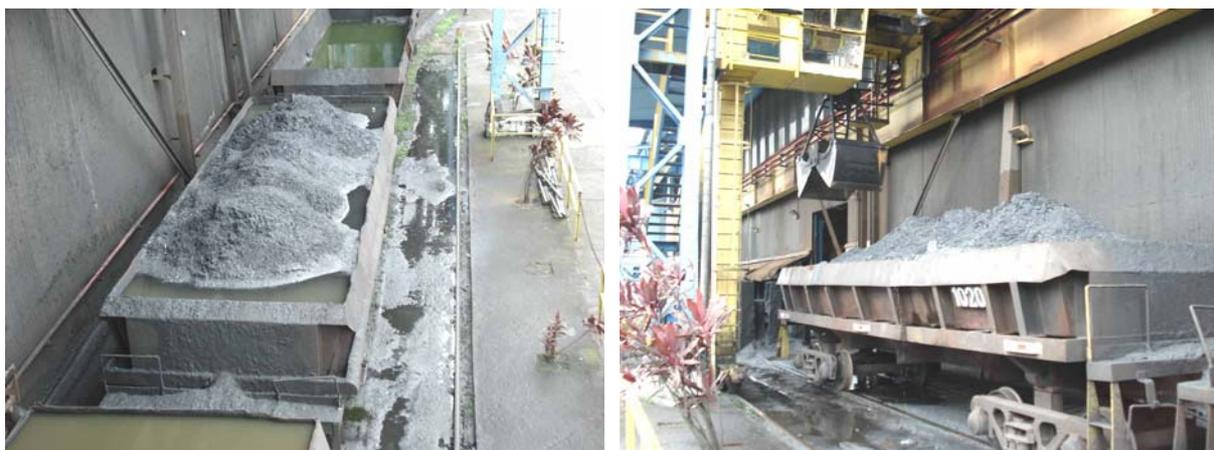
**Figura 6** – Vagões de transporte de carepa de laminação.
