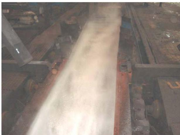
**Figura 3** – Jatos d'água de alta pressão para remoção da camada de óxido.
