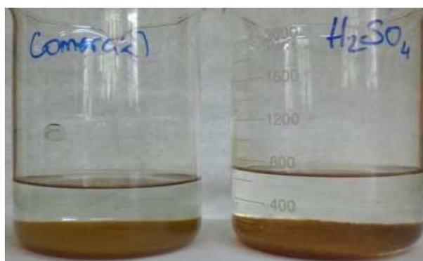
**Figura 3.** Ensaio de Jar Test de tratamento de água, sendo à esquerda com coagulante comercial produzido a partir de sucata metálica (SFCo) e à direita com o produzido com a em laboratório com carepa (SFCa).
