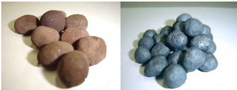
Figura 16. A foto da esquerda indica pelotas verdes e a foto da direita indica pelotas queimadas.
