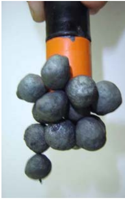
Figura 14. Pelotas atraídas por imã (Propriedades magnéticas).
