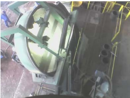
Figura 6. Foto do prato pelotizador de 3m de diâmetro
