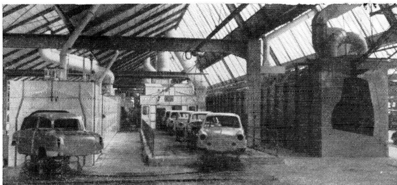
Fig. 12 — Vista frontal de uma instalação para acabamento de carrocerias de automóveis. A direita: instalação de fosfatização e limpeza; ao centro: lugar de aplicação de "filler"; à esquerda: secador para o "filler". (Werner e Pfeleiderer Maschinenfabriken e Ofenban Werke; Stuttgart, Alemanha).
