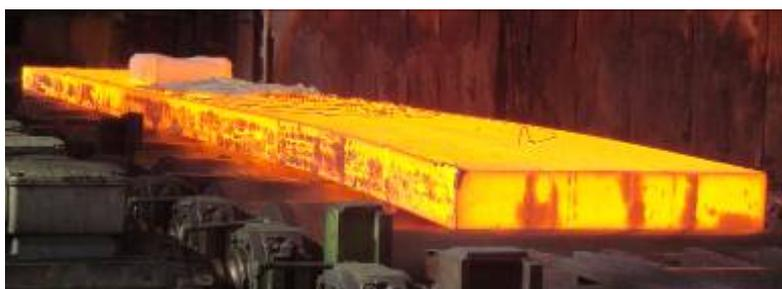
Figura 9. Desenformamento da Placa de Teste.
