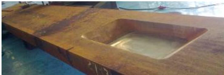
Figura 7. Placa de Teste em processo de usinagem.
