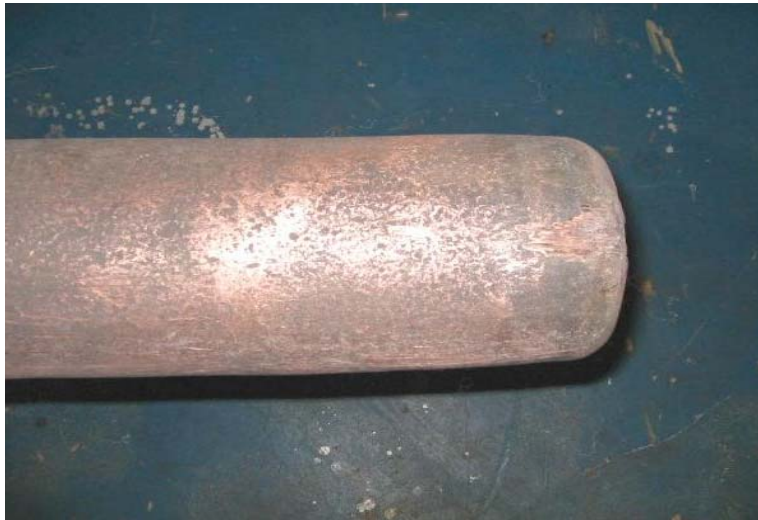
Figura 6. Foto mostrando a superfície externa da lança após a utilização em mais de 500 corridas. Nota-se que houve apenas pequenas variações superficiais na lança, porém, não ocorreu a fusão do metal.
