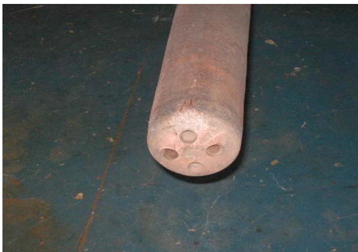
Figura 7. Foto do bico, onde se vê que a superfície do mesmo não apresenta variações dimensionais (deformações) e/ou avarias na superfície.
