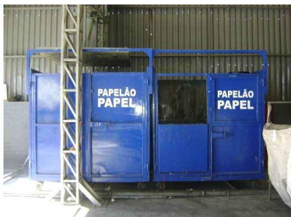
Figura 7. Situação Atual - Interior da Central de Resíduos – Prensa para os resíduos de papéis/papelões limpos e Bag's para a segregação e acondicionamento dos plásticos limpos.
