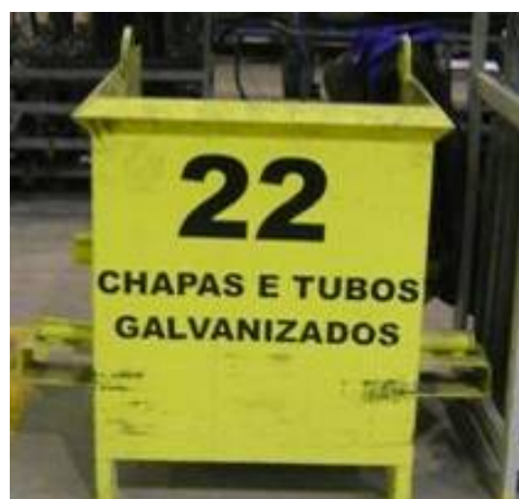
Figura 8. Situação Atual - Carrinhos coletores e Containers para o acondicionamento dos resíduos/sucata gerados na fábrica, que estão dispostos em cada linha de produção de forma a possibilitar a correta segregação/coleta seletiva dos resíduos na fonte geradora.
