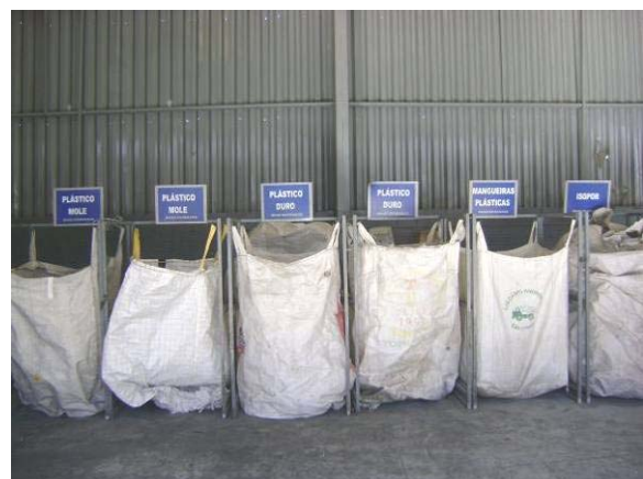
Figura 7. Situação Atual - Interior da Central de Resíduos – Prensa para os resíduos de papéis/papelões limpos e Bag's para a segregação e acondicionamento dos plásticos limpos.
