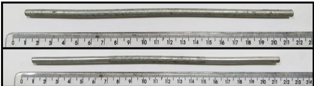
Figura 4. Corpo de prova antes (arame superior) e após (arame inferior) acabamento superficial nas extremidades.
